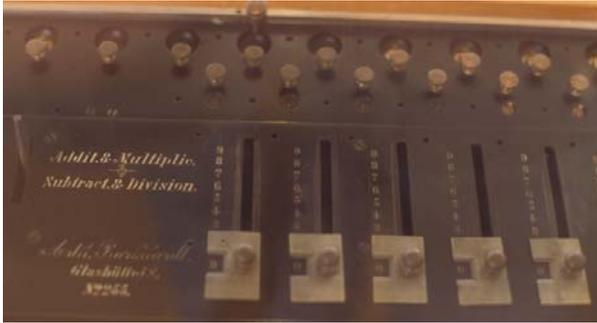
**Abb. 8: Burkhardt-Arithmometer<sup>1</sup>**
