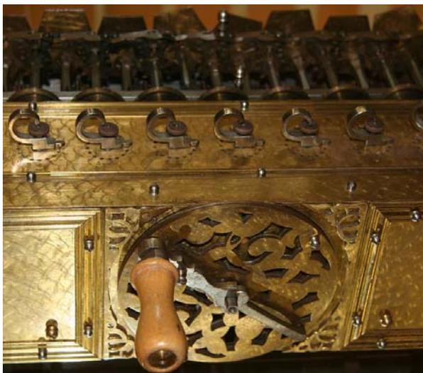
**Abb. 2: Zentrale Antriebskurbel und Teile des Eingabe- und Resultatwerks<sup>1</sup>**
