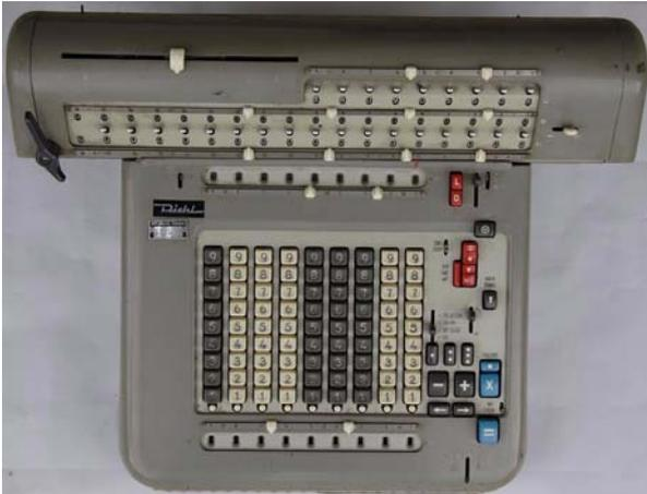
**Abb. 31: Diehl VSR18 (Vollautomat – Speicher – Rückübertragung – 18 Stellen im Resultatwerk)**
