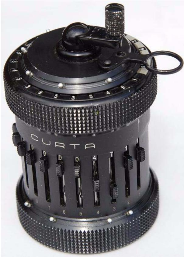
Abb. 35: Curta Modell II mit elf Stellen im Eingabewerk, acht Stellen im Umdrehungszählwerk und 15 Stellen im Resultatwerk
