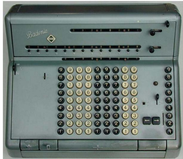
**Abb. 34: Die „Badenia Modell TE 13“; rechts die Tastenreihe für Multiplikator bzw. Divisor**
