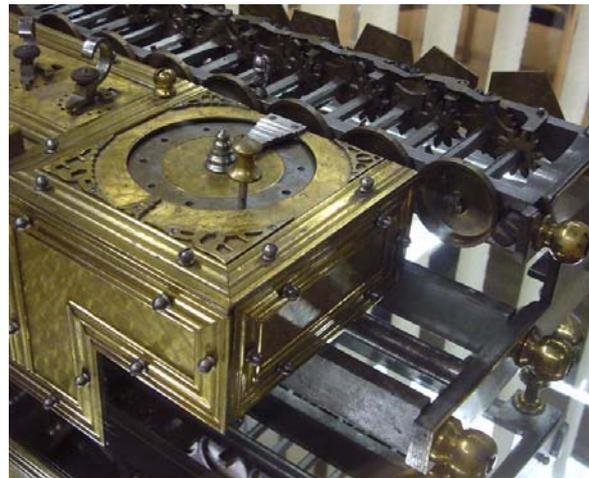
**Abb. 3: Umdrehungszählwerk auf dem Schlitten und rechter Teil des Resultatwerks<sup>2</sup>**
