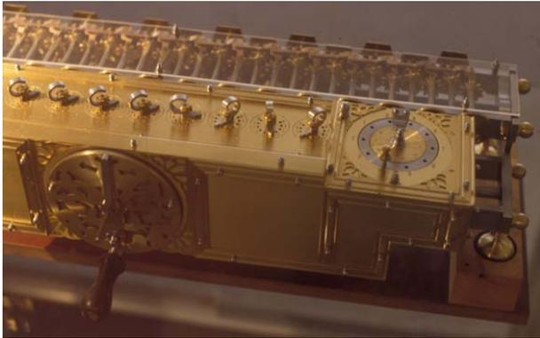
**Abb. 5: Rechter Teil mit Umdrehungszählwerk<sup>2</sup>**
