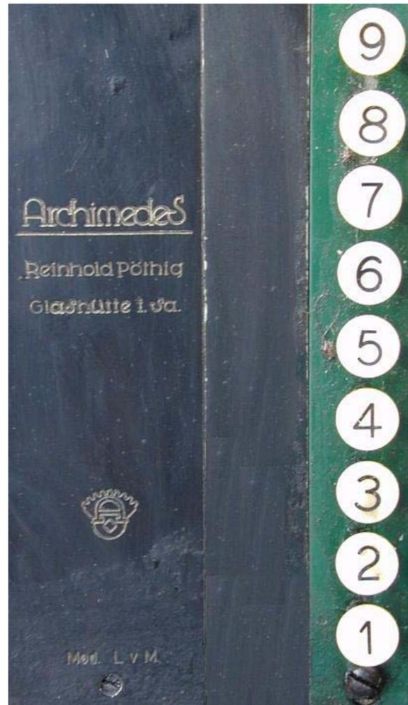
Abb. 22: Beschriftung der Maschine, daneben die höchstwertige Stelle der Eingabe-Volltastatur
