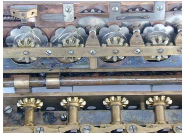
**Abb. 15:** (Obere Bildhälfte: Schlitten hochgeklappt) Beim Zehnerübertrag schiebt die Excenterscheibe unter dem Zählrad (links oben gut zu erkennen) den Einzahn in die Übertragsposition (über den Hebel am unteren Bildrand)
