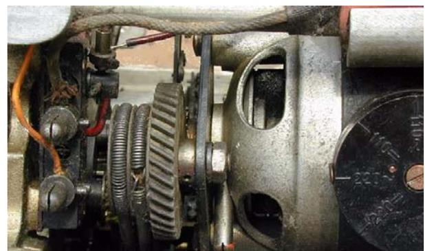
Abb. 23: Der Antriebsmotor mit Stiften für den Gerätestecker (links) und Wählscheibe für die Versorgungsspannung (rechts)
