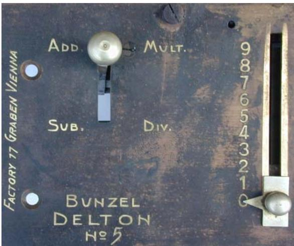
Abb. 17: Der Umschalthebel „ADD./MULT“ / „SUB/DIV“, dessen Fortsetzung unter die Einstellplatte in Abb. 19 zu sehen ist
