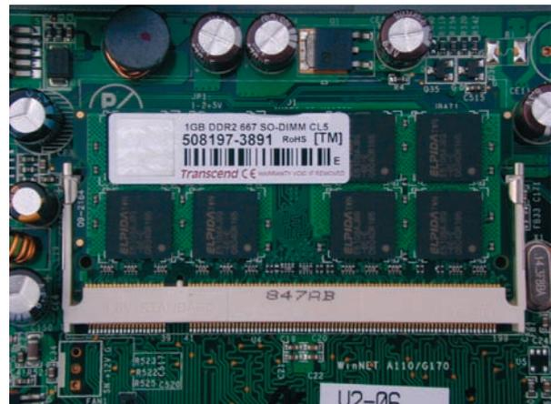
Abb. 2: RAM-Speichermodul mit 1 GByte Kapazität
