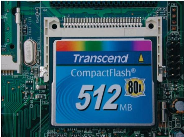
**Abb. 3: Flash-Speichermodul mit 512 MByte Kapazität**
