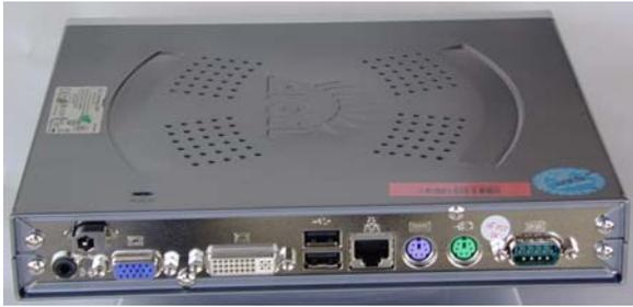
**Abb. 2: Rückansicht des Thin Clients**
