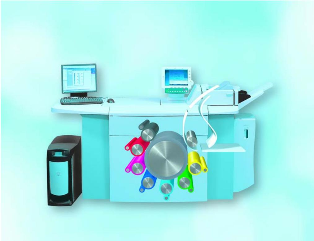
**Abb. 4: Kurze Papierwege im Druckwerk CPS900 helfen, Papierstaus zu vermeiden. Links daneben ist der CPS1000C-Ripserver zu sehen**
