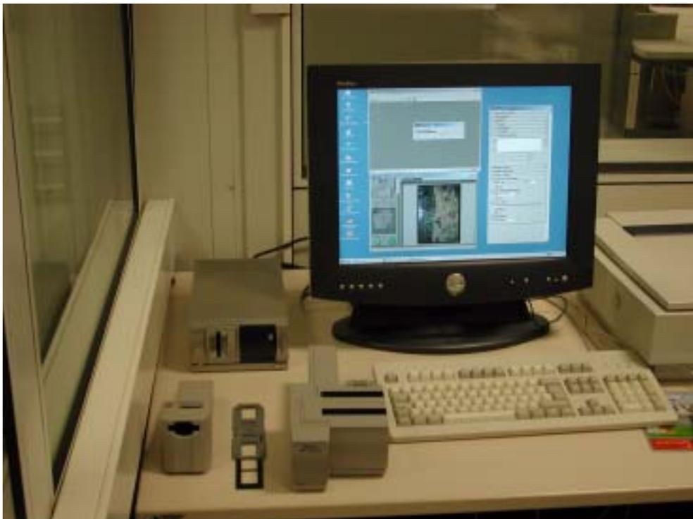
**Der Arbeitsplatz mit Nikon LS400ED Diascanner mit eingeschobenen Diarahmenadapter MA-20(S) und Zubehörteilen (von links nach rechts): automatischer Filmstreifeneinzug SA-21, Filmstreifenhalter FH-3 und Diamagazin SF-200**
